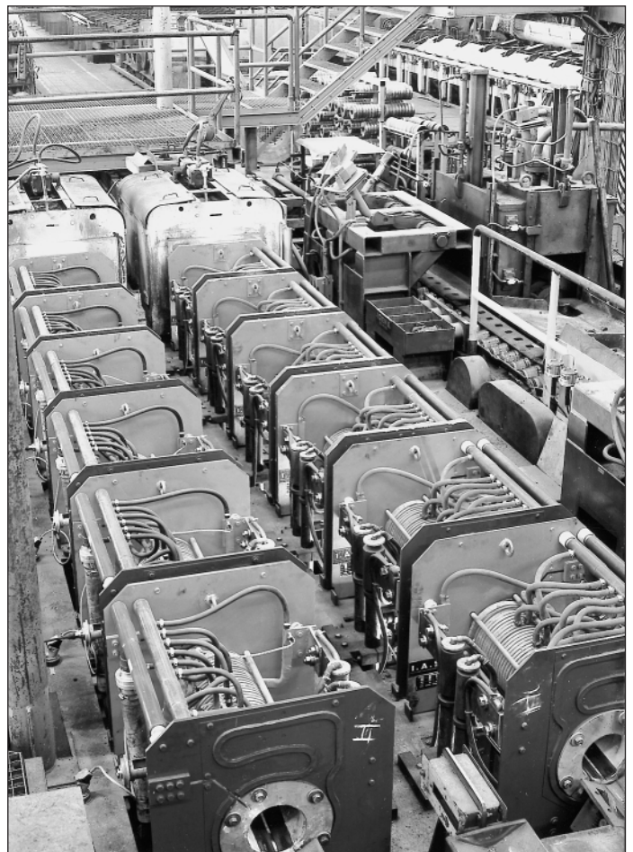
Bild 2: Horizontale Anord- nung der Indukti- onsspulen für die Grunderwärmung
