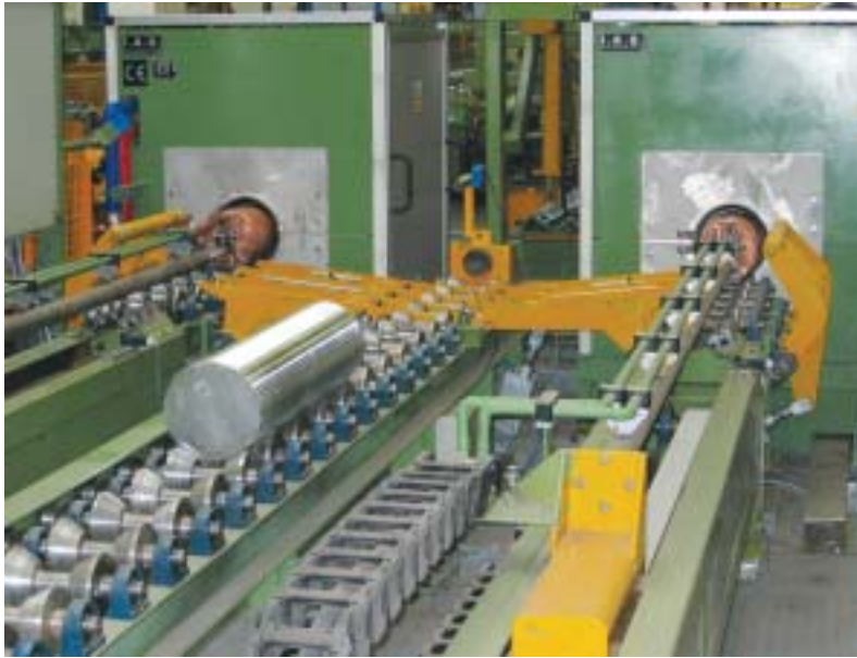
Bild 4: Zwei parallel angeordnete Einbolzen-Induktionsöfen mit individuell regelbaren Heizzonen
