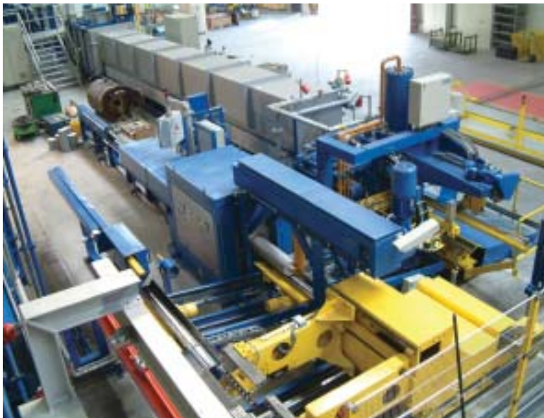
Bild 1: Übersicht einer kombinierten Blockerwärmungsanlage mit Gasöfen, Warmschere und induktiv beheizten Einbolzenöfen (Bilder: I.A.S.)
