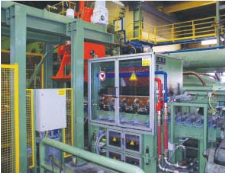
Bild 3: Ansicht 6 Zonen Einbilzen-induktionsofen System (TEM-Pro-Heater)
