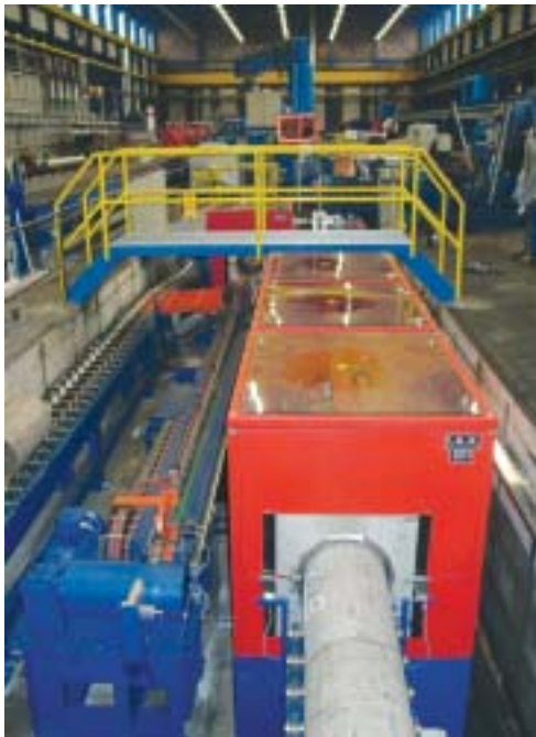
Bild 5: Kombinierte Induktionsofenanlage mit induktiver Vorerwärmung und nachgeschalteten TEM-Pro-Heater
