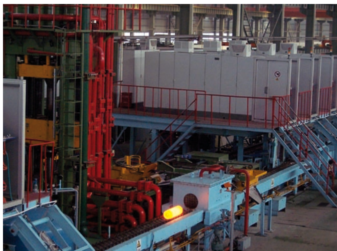
Bild 4: Lochpresse und vertikale Nacherwärmung
