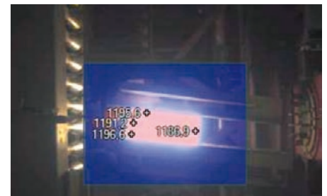
Bild 10: Thermografische Auswertung des Einsatzgutes nach der Nacherwärmung
