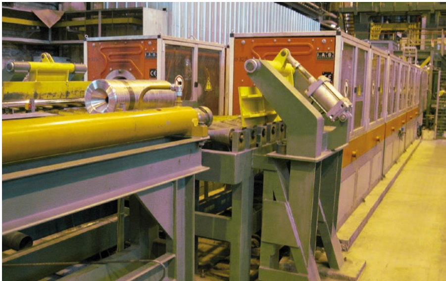
Bild 2: Induktive horizontale Grunderwärmung
